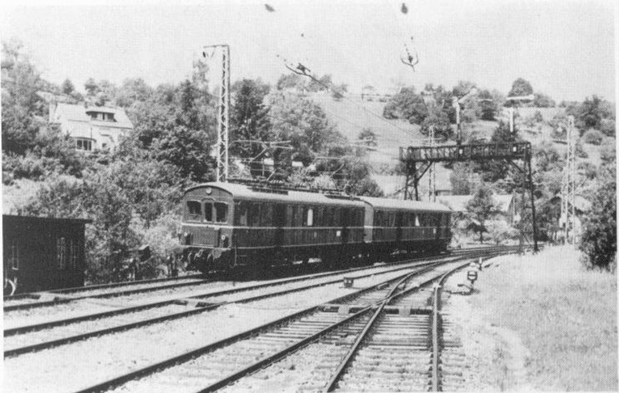
ET 85 bei der Ausfahrt Richtung Schopfheim. Diese Triebwagen hielten bis zur Stilllegung der Wehratalbahn den Personenverkehr aufrecht. Die Triebwagen wurden 1927-1933 in Bayern in Betrieb genommen. Höchstgeschwindigkeit: 75/100 km/h; Leistung: 500 kW. (Foto: Gerber, 1971)
